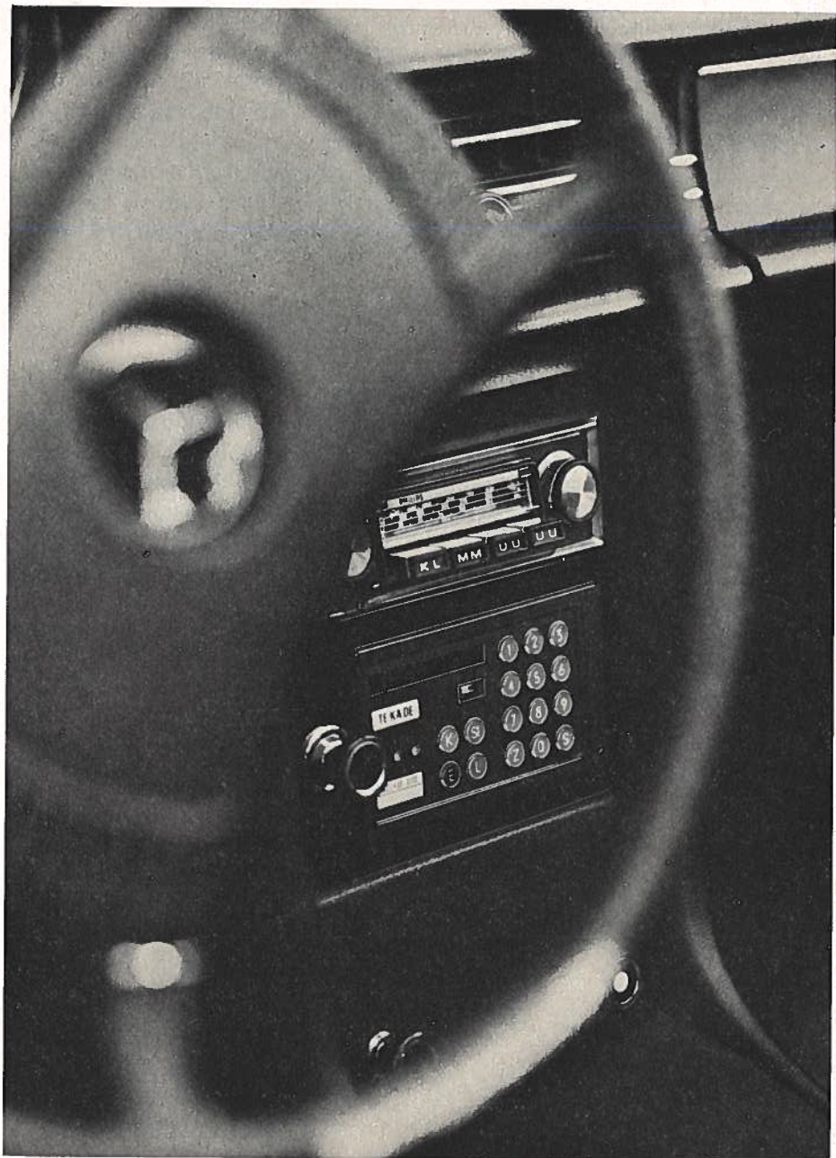
Fig. 3. Voorbeeld van bedieningskastje automatisch openbaar landelijk net.
